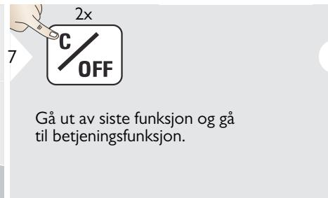
7 Gå ut av siste funksjon og gå til betjeningsfunksjon.
