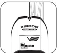
2. Con el Botón de Encendido presionado, deslice el detector lentamente por la pared. Cuando el detector encuentre el borde de la viga, aparece el Indicador de EDGE (BORDE) en la pantalla. (Figura B)
